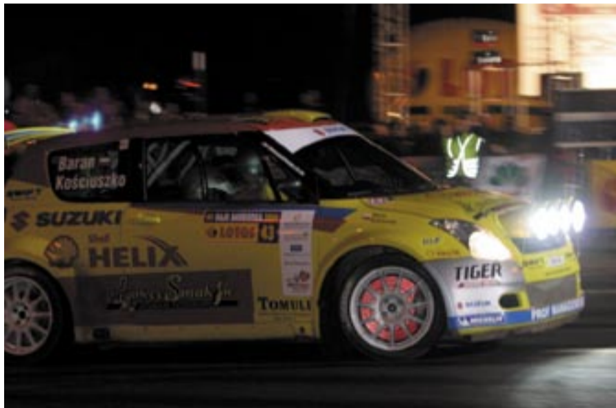
W czasie hamowania ogromne ilości ciepła wytwarzane są przy tarceniu klocków o tarcze. W uproszczeniu hamowanie polega na zamianie energii kinetycznej poruszającego się auta na ciepłą rozpraszaną w czasie chłodzenia tarcz hamulcowych.
