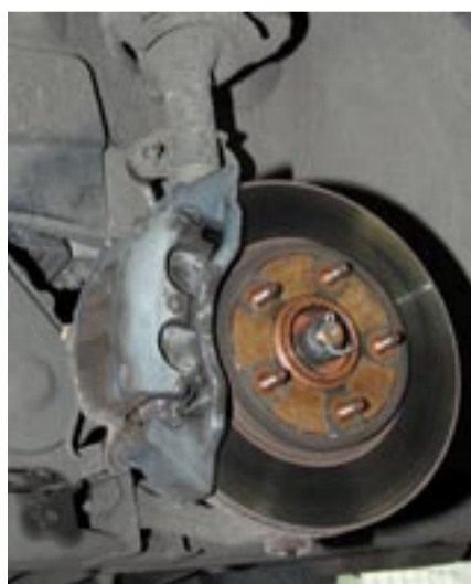
Po zdjęciu koła można wizualnie ocenić stan klocków hamulcowych, tarcz i zacisku. Pełna weryfikacja tłoczków i uszczelniaczy wymaga rozebrania hamulca.
